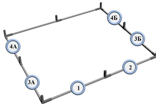
**2. установите стойки (поз. 5) на торцевые стойки установите удлиннители стоек (поз. 6)**
