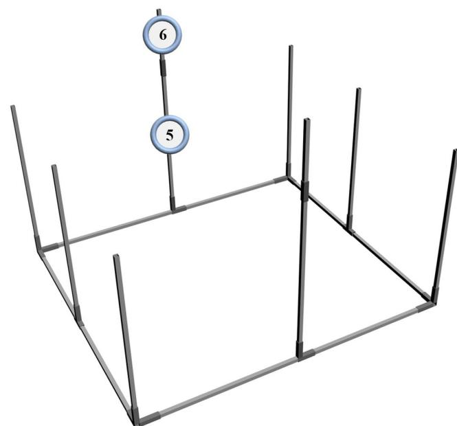
**3. установите на стойки часть крыши**
